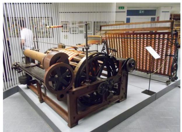
Sektionskettmaschine mit Gatter
