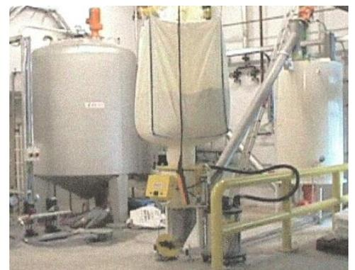
Die Firma Geplan hat das Tätigkeitsfeld inzwischen auf erneuerbare Energien ausgerichtet. Konkret haben wir eine Versuchslinie aufgebaut für die Umesterung von Altfett aus Bäckereien zu Biodiesel.
